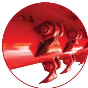
Mazze Ø19mm Hammer Ø19 mm
